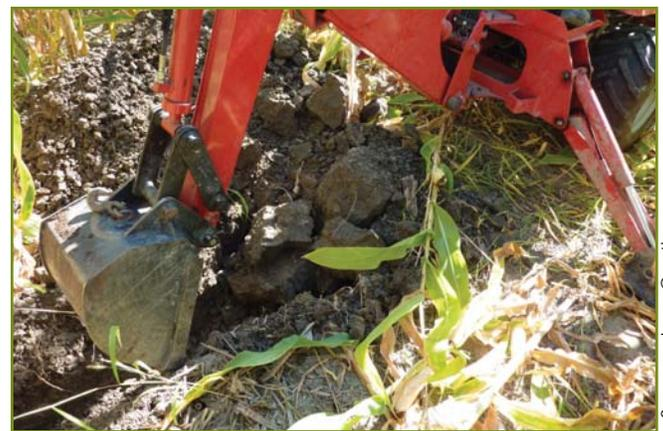
Figure 24. Signes apparents de compactage à la suite du double passage d'une citerne à lisier en postlevée sur le site d'essai n° 2
