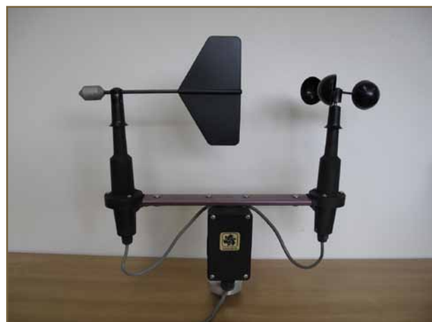
FIGURE 7. GIROUETTE ET ANÉMOMÈTRE À COUPELLE ÉLECTRONIQUE
