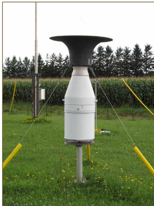
FIGURE 5. PLUVIOMÈTRE À PESÉE
