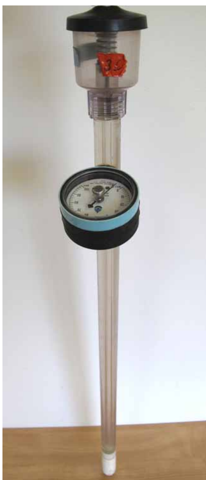
FIGURE 9. TENSIOMÈTRE AVEC EMBOUT EN CÉRAMIQUE
