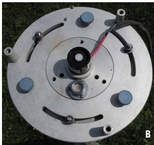
FIGURE 8. PYRANOMÈTRE (A : VUE DE CÔTÉ, B : VUE DE DESSUS)
