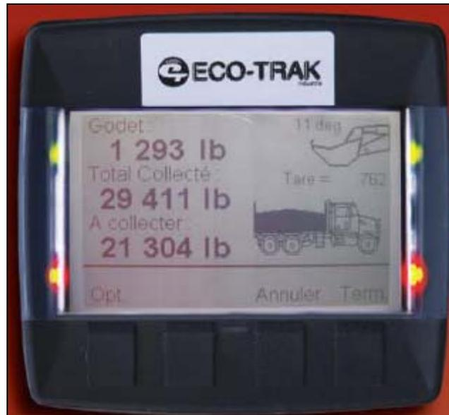
Figure 3.10 : Exemple de console de bord pour les balances pour chargeurs frontaux
