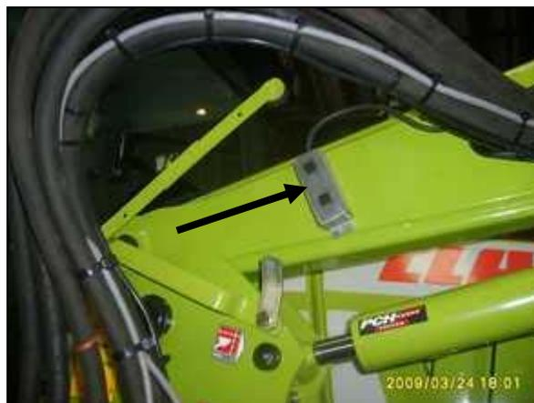
Figure 3.11 : Exemple de capteur de position installé sur un chargeur de tracteur
