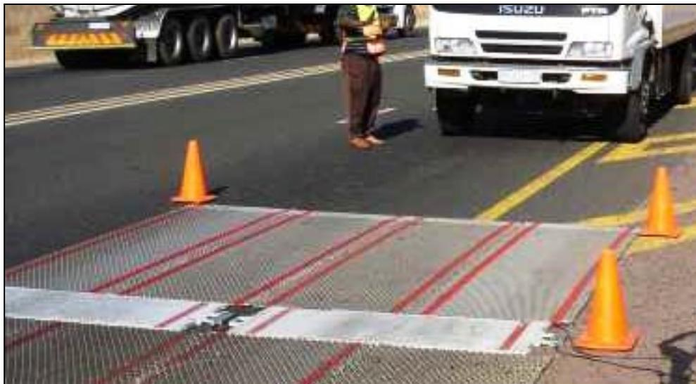
Figure 3.4 : Balance de roues souple
