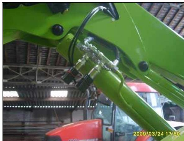
Figure 3.9 : Exemple de capteur de pression hydraulique servant à la mesure de la masse contenue dans le godet
