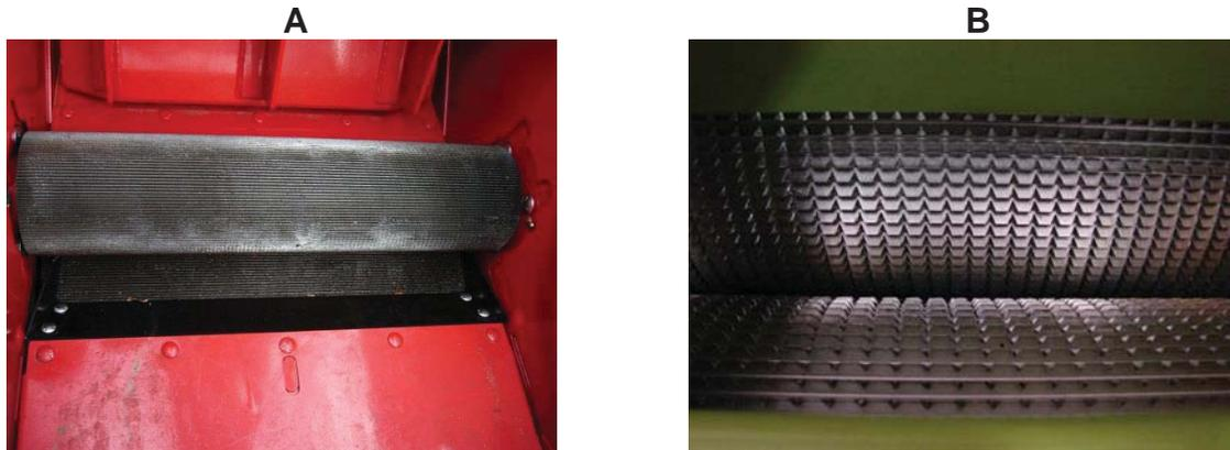
Figure 4. Rouleaux craqueurs conventionnels (A) et rouleaux de la technologie Shredlage<sup>mc</sup> (B).
