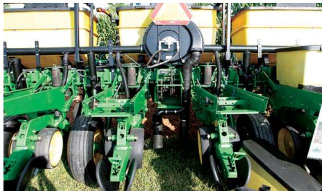
et d'autre part sur un tuyau flexible de quatre pouces. Pour ralentir le débit d'air, des pièces de plastique ont été fixées à l'intérieur du tuyau. Vers le bas, le tuyau a été divisé en deux, ce qui contribue aussi à atténuer la force des jets d'air à leur sortie près du sol.
