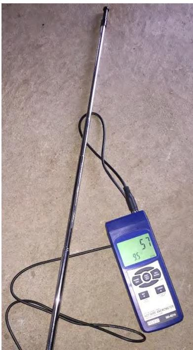
**Anémomètre à fil chaud, thermomètre (400 \$)**
