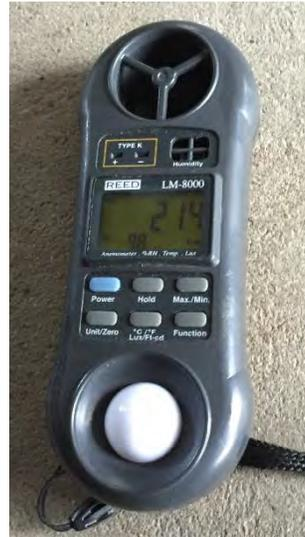
**Photomètre, hygromètre, thermomètre, anémomètre vitesse haute et modérée (120 \$)**
