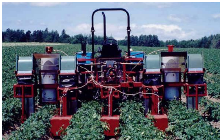
Figure 2. Prototype de pyrodésherbeur combiné à un système pneumatique pour déloger les doryphores des plants (Khelifi et al. , 2007)
